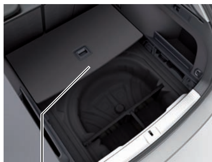
Сложенный трансформируемый пол багажного отсека
