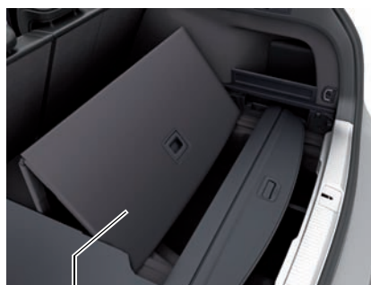
Трансформируемый пол багажного отсека в вертикальном положении
