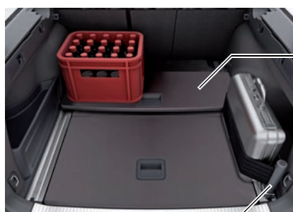
Сдвижная петля крепления багажа с ремнём
