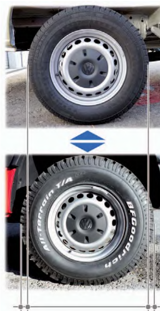
Разный путь, проходимый шинами за один оборот
