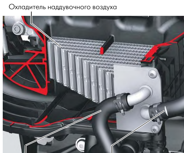
Подающий контур ОЖ Обратный контур ОЖ S405_049
